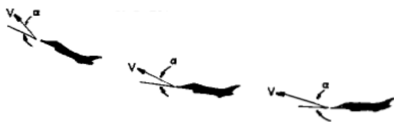
شکل (۳): نیروی برای مستقیم - کنترل مسیر پرواز در زاویه حمله ثابت Fig. 3: Direct lift control - vertical flight path control at constant angle of attack
